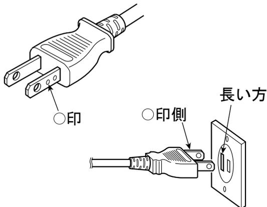
本機の電源プラグには、左図のように○印が片側に入っています。これは各機種種の電源の極性を合わせ、より良い音質を得るためのものです。コンセントの屋内配線、及び電源事情により異なる場合がありますが、一般的にはコンセントの差し込み口の長い方に○印がくるようにします。
