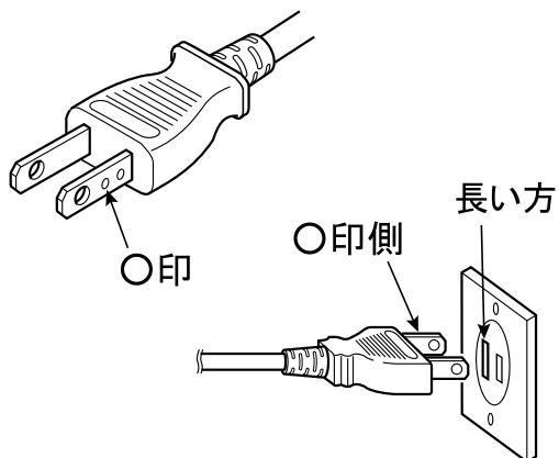
本機の電源プラグには、左図のように○印が片側に入っています。これは各機種の電源の極性を合わせ、より良い音質を得るためのものです。
