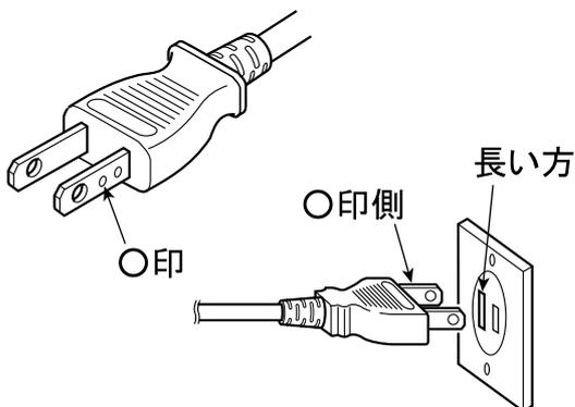
本機の電源プラグには、左図のように○印が片側に入っています。これは各機種種の電源の極性を合わせ、より良い音質を得るためのものです。コンセントの屋内配線、及び電源事情により異なる場合がありますが、一般的にはコンセントの差し込み口の長い方に○印がくるようにします。
