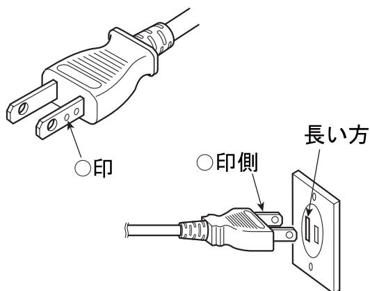
本機の電源プラグには、左図のように○印が片側に入っています。これは各機種の電源の極性を合わせ、より良い音質を得るためのものです。
