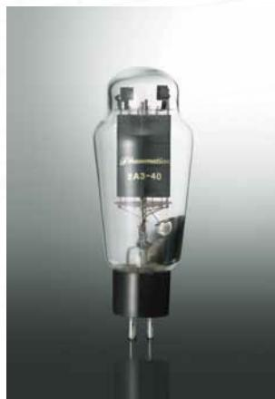
出力管に選んだ「2A3-40」は、自己バイアス電源による安定動作を確保した純A級・シングル動作という「2A3」が持つ本来の素性の良さを最もシンプルな動作で発揮できる構成としました。この「2A3-40」は、オリジナル「2A3」のプレート損失15Wに比べ40Wと実に2倍以上もあり、外形も2回り程度大きくなっています。それを30W弱で余裕をもって動作させながら最大出力10Wを実現しています。
